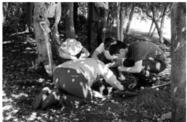
図6. 深度50cmの穴を掘って土壌断面を観察
