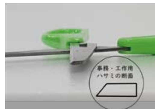
事務・工作用ハサミの断面
